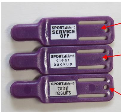
setzt die Station in Standby; mit dem nächsten Chip wird sie wieder aktiv.
